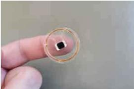
Ein RFID Transponder ist ein Mikrochip mit einer Antenne, der Informationen speichern und wiedergeben kann. Mikrochip wird über elektromagnetischen Wellen mit Energie versorgt
