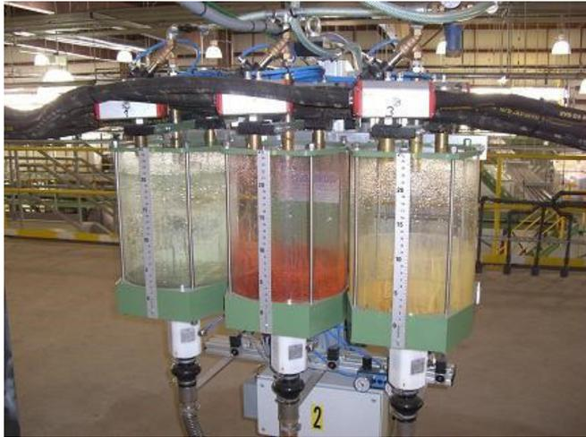
Farbwaage mit drei Zylindern und je 2 Farbanschlüssen für insgesamt 6 Farben.
