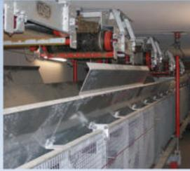
Wiegebänder mit durchgehenden Führungsblechen, ggf. Blecherhöhung an DG-Abwurfstellen und Verschleißblechen aus Hardox
