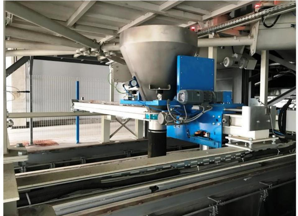
Pulverwaage zur Entleerung im freien Fall auf Bänder, in Aggregatwagen oder Aufzüge
