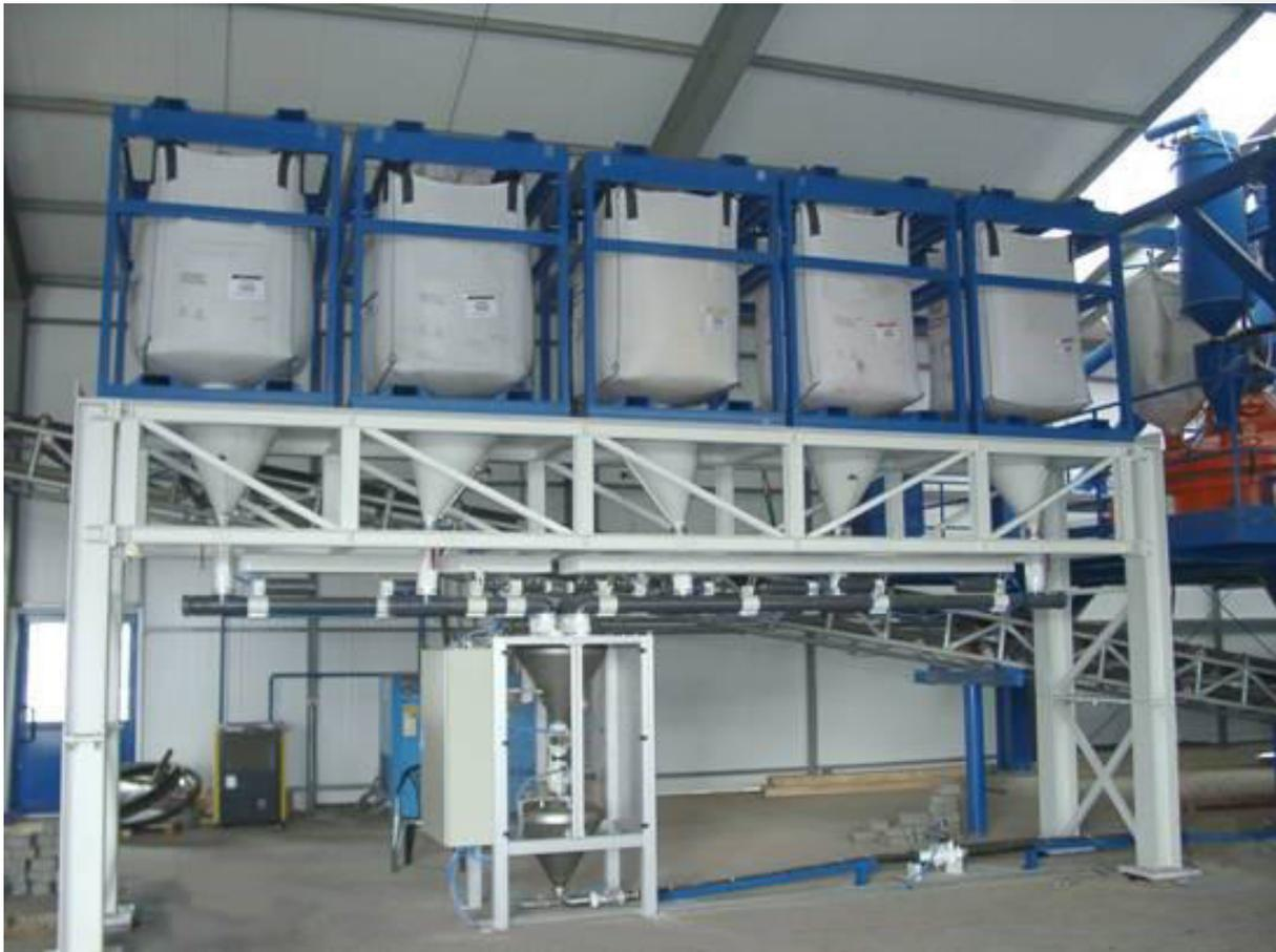
Für pneumatische Förderung mit 5 Farben, aus Big-Bag, eine Waage, ein Drucksender, mit einer Rohrweiche in 2 Mischer
