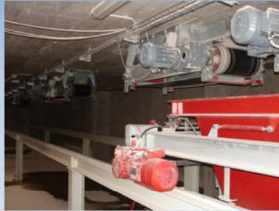
Waage unter Dosiergeräten - Reihenanordnung
