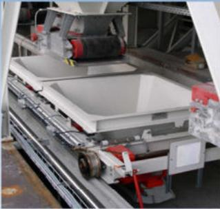
Doppelbehälterwaage unter Dosiergeräten
