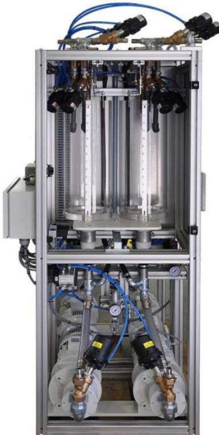
AC 15/15 mit Entleerpumpen zur ebenerdigen Aufstellung, z.B. in beheizten Räumen, Gute Zugänglichkeit.
