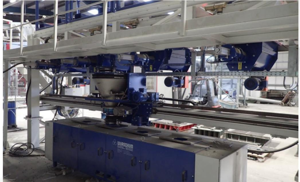
Fahrbare Pulverwaage zur Entleerung in einen oder mehrere Druckbehälter zur pneumatischen Förderung in die Mischer.
