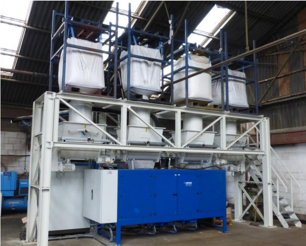
Weiterentwickelte Dosieranlage für pneumatische Förderung von günstigen Pulverpigmenten mit bis zu 6 Sendebehältern, z.B. für Color-Mix Produkte
