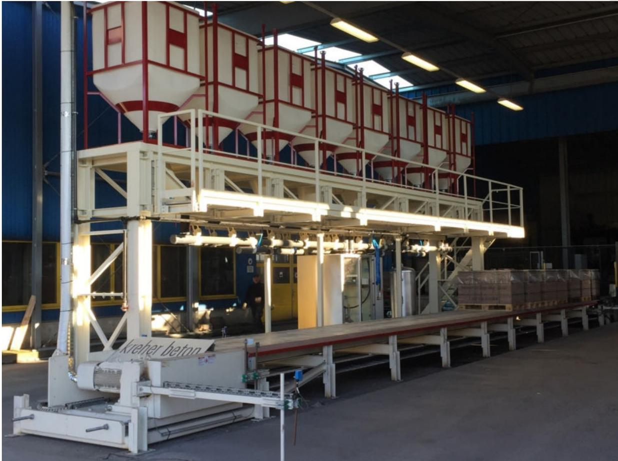
Für pneumatische Förderung mit 8 Farben, aus Containern (Big-Bag), eine Waage, ein Drucksender, mit einer Rohrweiche in 2 Mischer
