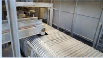
Übergabe Dosiergerät in eingekapseltes Wiegeband mit Absaugung
