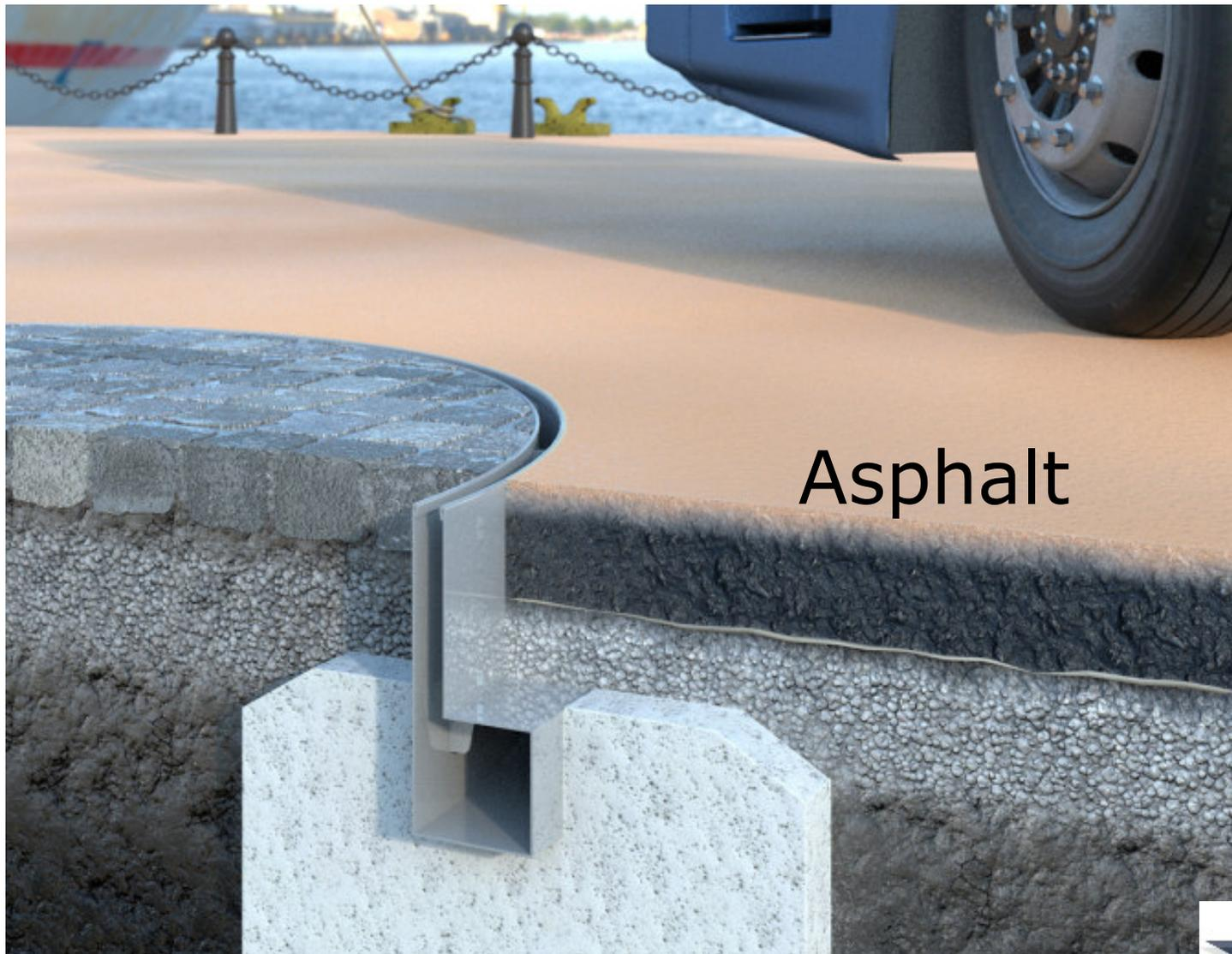
Bewegungsfugen: aus Polyolefin (vernetzter PO-Schaumstoff)
